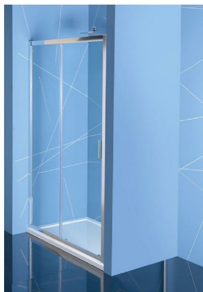
PROSKLENÉ SPRCHOVÉ DVEŘE DO NIKY 1100mm, DVOJDÍLNÉ Horní a spodní zdvojené ložiskové pojezdy Systém vyklápění dveří pomocí spodních ložisek pro snadné čištění Dveře jsou děleny na část posuvnou a část pevnou Materiál : bezpečnostní čiré sklo o síle 6 mm leštěné hliníkové profily
